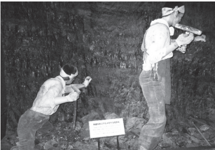
火薬装填用の穴を開けている
